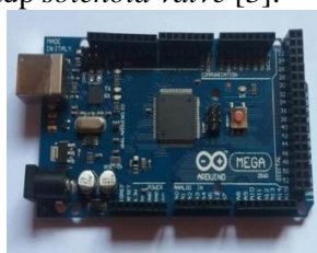
Gambar 1. Arduino Mega 2560 R3
