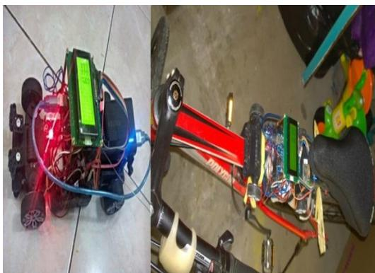
Gambar 15. Rangkaian sistem secara keseluruhan pada mobil RC dan sepeda
