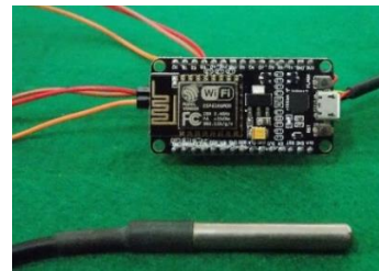
Gambar 16. Implementasi sensor suhu DS18B20 dengan NodeMCU
