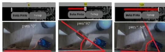
Gambar 25. Kondisi Pintu pada pwm dari 0, 90 dan 180
