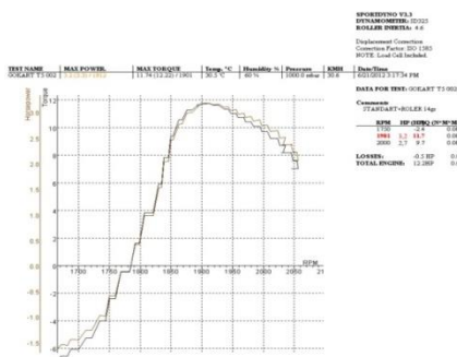
Gambar d.5 Grafik Max power dan Max torsi dari roller 14 gram.
