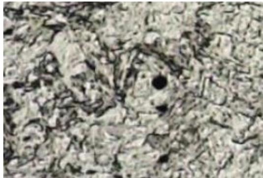
**Gambar 4. Struktur mikro baja C-Mn hasil *quenching* dan *tempering***
