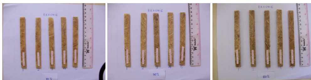
Gambar 1. Spesimen Uji Bending Komposit Berpenguat Serat Pohon Pisang
