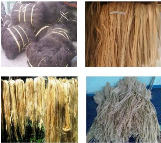
Gambar 4. Serat ijuk (aren), serat pisang, Serat abaca dan serat nenas digunakan untuk komposit
