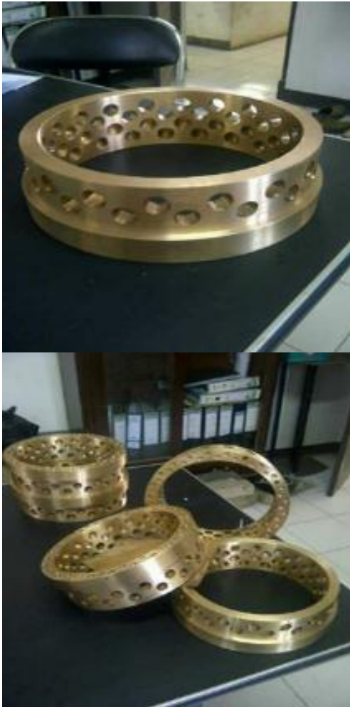
Gambar 10. Hasil akhir bushing sebelum dipasang grafit
