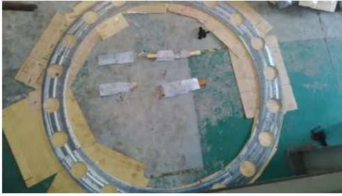
Gambar 7. Penyusunan faceplate untuk verifikasi geometri
