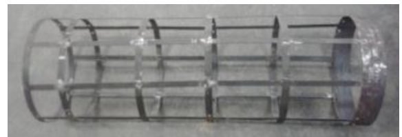
Gambar 4. Kerangka ayakan 1 (ayakan dalam)
