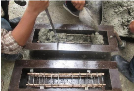
**Gambar 3.4.** Benda uji balok beton bertulang bambu
