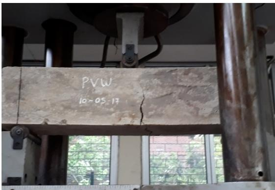
**Gambar 3.5.** Pengujian beban lentur
