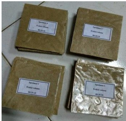
Gambar 1. Panel green composite material berbahan material limbah dari styrofoam , serbuk ampas tebu dan serbuk cangkang telur
