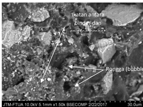
Gambar 6. Fracture surface dari green composite dengan fraksi volume 70%:15%:15%
