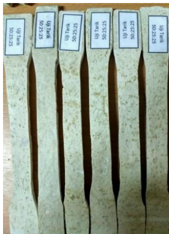
Gambar 2. Spesimen uji tarik komposit berdasarkan ASTM D-638
