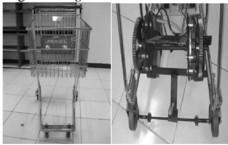
Gambar 10. Troli, (a) Keadaan awal, (b) Bagian belakang troli setelah dipasang motor dan gear
