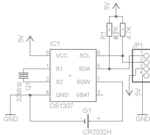
Gambar 5. Rangkaian RTC IC DS1307
