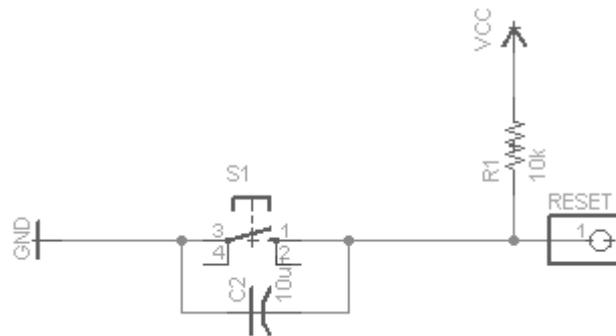
Gambar 10. Rangkaian Reset Atmega 8535 Central Unit.
