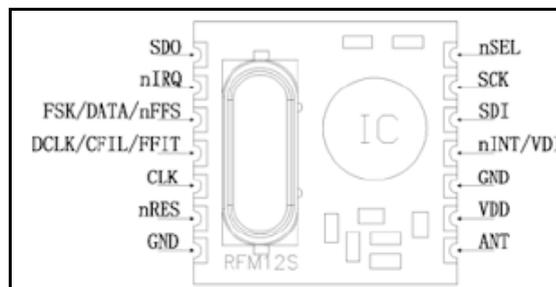
Gambar 3. Konfigurasi Pin RFM12-433S [4]
