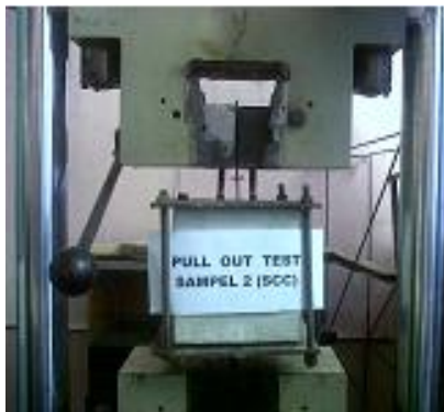
(a) Pengujian Pullout
