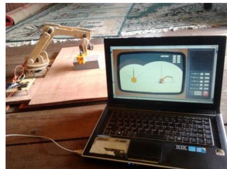
Gambar 12. Visualisasi robot lengan saat mengambil objek pada posisi yang ditentukan
