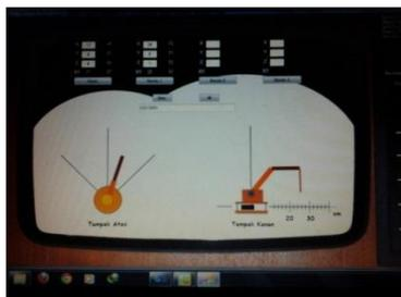
Gambar 14. Posisi robot mengambil objek 1 dan visualisasinya
