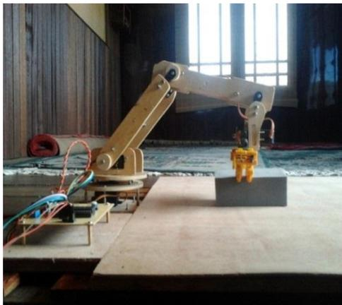
Gambar 10. Pengendalian robot lengan menggunakan *Visual Basic*
