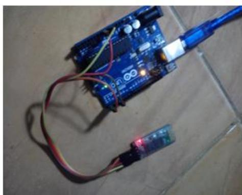
**Gambar 15.** Rangkaian Arduino dengan Module *Bluetooth*
