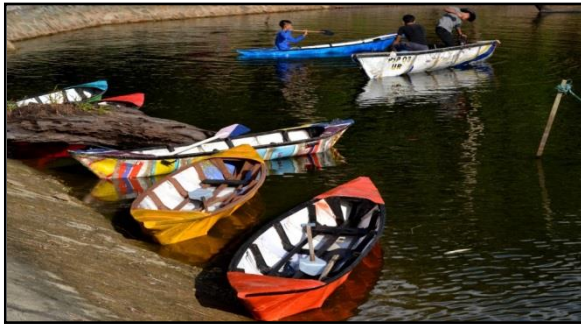
Gambar 1. Sampan yang di buat dari ember cat bekas
