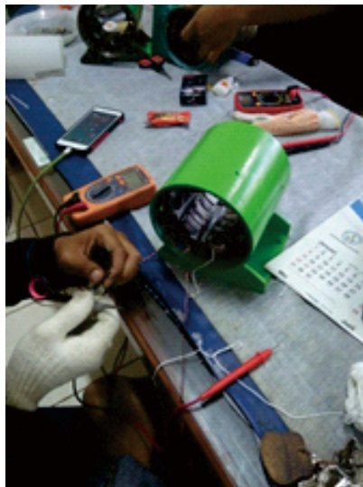
Gambar 4. Pembuatan lilitan kumparan stator generator magnet permanen
