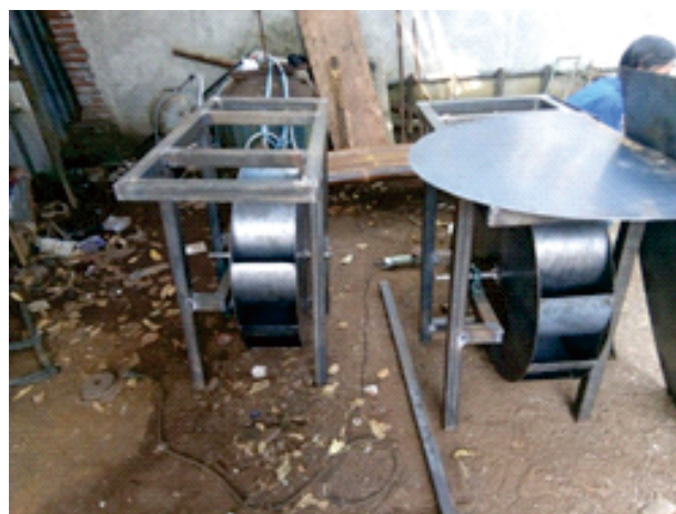
Gambar 7. Proses pembuatan turbin air skala pikohidro
