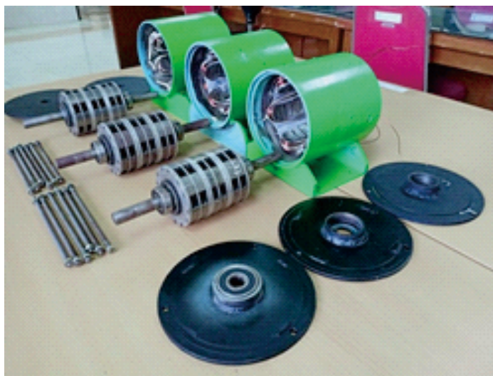
Gambar 5. Konstruksi dari rumah lilitan kumparan stator, rotor generator magnet permanen, mur-baut panjang pengikat dan tutup depan-belakang generator magnet permanen.
