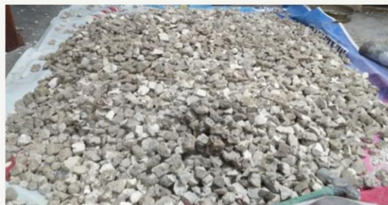
Gambar 3. Agregat Kasar Sumba Barat Daya
