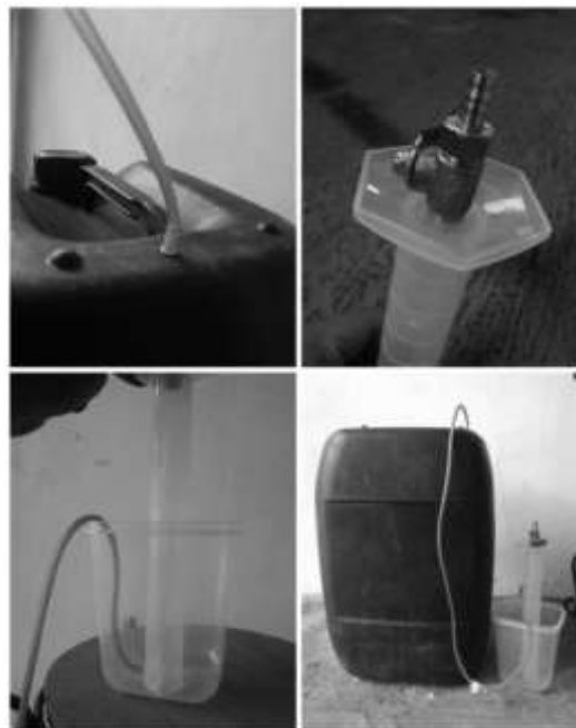
Gambar 4. Fermentor kapasitas 20 liter dengan perangkat pengukur volume dan uji nyala.
