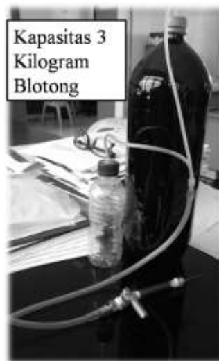
Gambar 1. Fermentor pada tahap penelitian pendahuluan. Kapasitas 3 Kg Blotong
