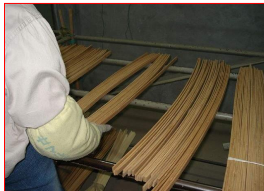
Gambar 2. Lantai dari Bambu Laminasi dan Pembuatan Bambu Laminasi dari Bilah-bilah Bambu
