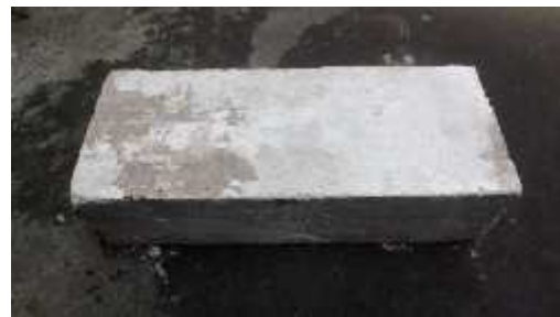
Gambar 1. Bata ringan berbahan dasar limbah pengolahan emas
