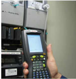
Gambar 4.1 Pembacaan Langsung Dengan Meter Reader
