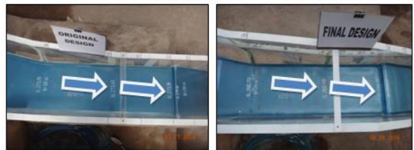
Gambar 13. Kondisi Saluran Transisi di Model Fisik Hidrolik
