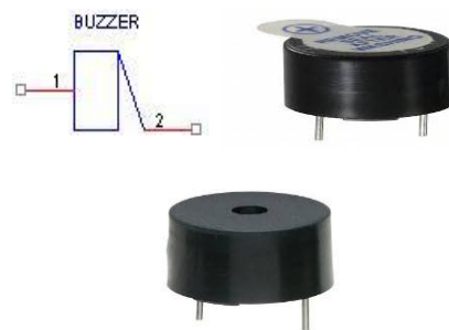
Gambar 7. Simbol Buzzer dan contoh fisiknya (Horowitz, 1985)
