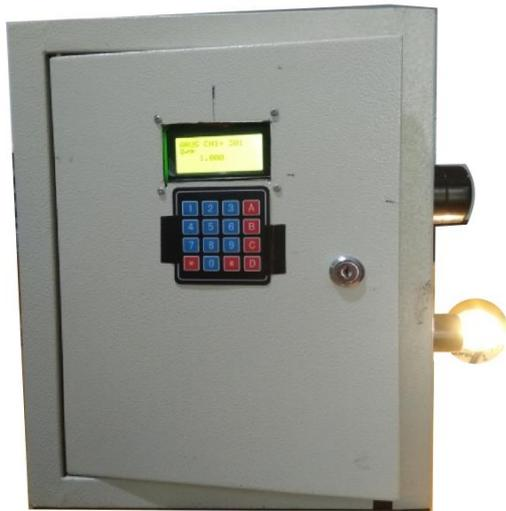
Gambar 7. Hasil rancangan alat ukur konsumsi energi listrik
