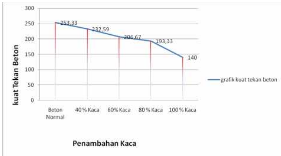
Gambar 1. Grafik Penurunan Kuat Tekan Beton
