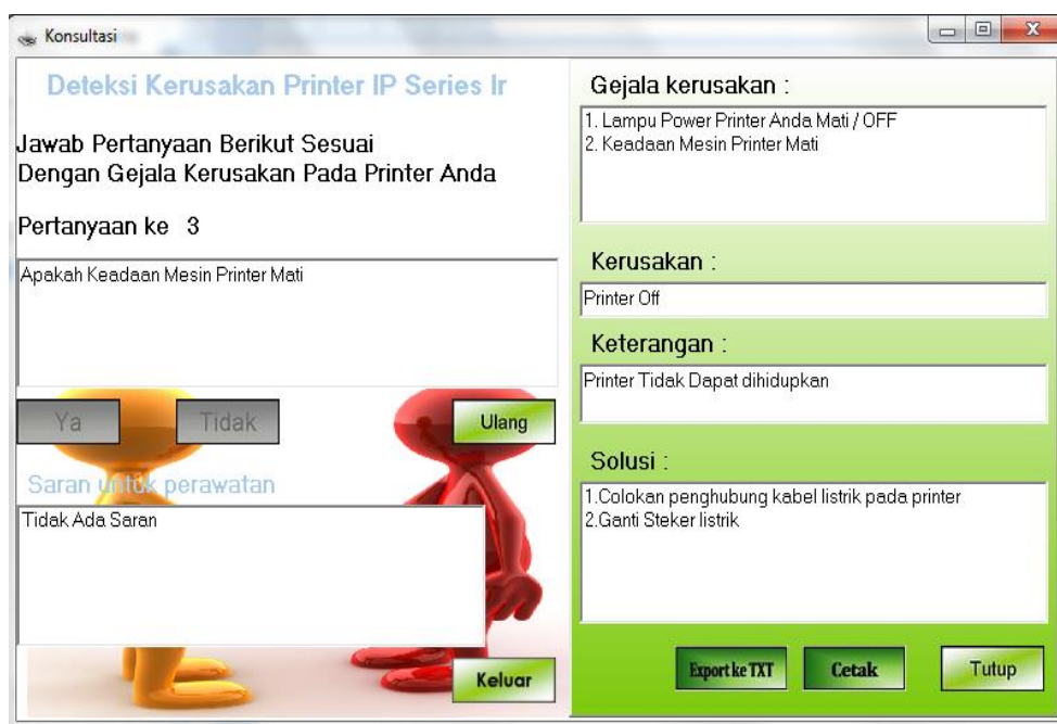
Gambar 4. 4 Proses Deteksi Kerusakan
