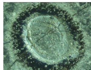
Gambar 16. Spesimen Hasil Uji Korosi 3.5% NaCl pada Tegangan Listrik Pengelasan 1.60 Volt.
