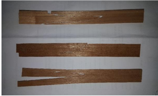
Gambar 4.1. Hasil Uji Tarik Spesimen Kayu Mahoni
