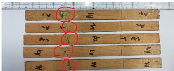
Gambar 4.2. Hasil Uji Tarik Spesimen Anyaman Plain
