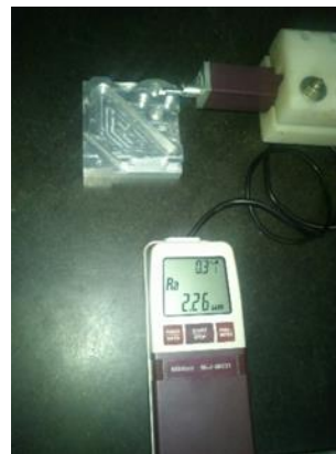
Gambar 2. Skema pengambilan data kekasaran permukaan.
