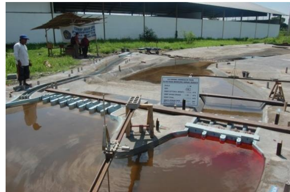
Gambar 14 Tes kondisi desain (model seri II)
