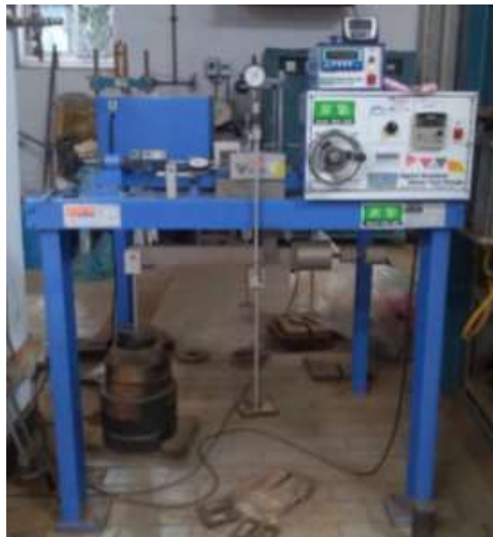
Gambar 2. Alat uji geser langsung konvensional
