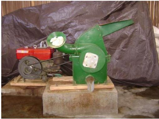
Gambar 3. Mesin penepung dan pembuat pelet
