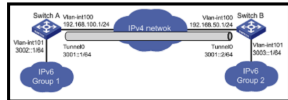
Gambar 1 Metode transisi Tunneling
