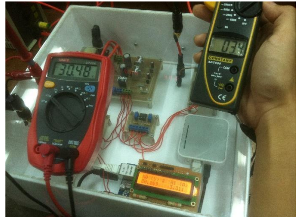
Gambar 11. Hasil pembacaan ditampilkan pada LCD 16x2 setiap 5 detik
