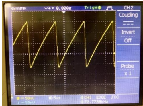
Gambar 4. Respon sinyal PWM untuk boost converter
