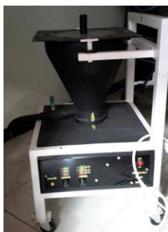
Gambar 3. Alat Penghancur Sampah Organic Otomatis
