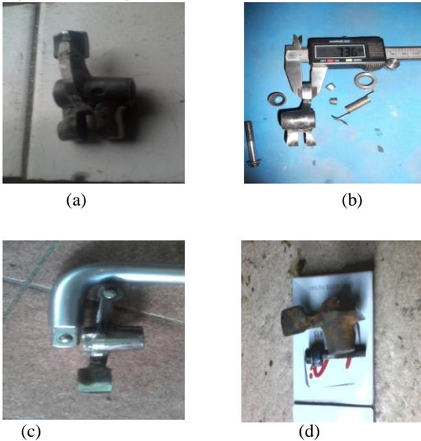
Gambar 3 : rocker arm standart dipotong dan dilas untuk penutup valve
