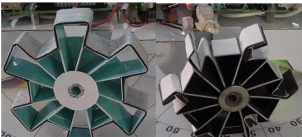
Gambar 4. Setup roda normal (kiri) dan roda rusak (kanan)
