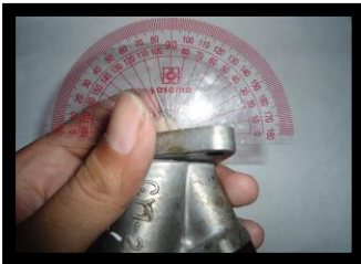
Gambar 3. Cara mengukur sudut manifold modifikasi
