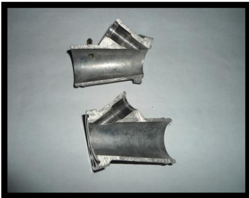
Gambar 2. Manifold standart yang telah dibelah menjadi dua bagian “Sudut yang berhadapan akan sama besarnya”.
