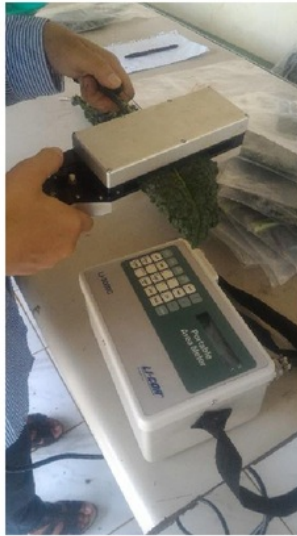
Gambar 2. Pengukuran Luas Daun dengan LI-3000c
